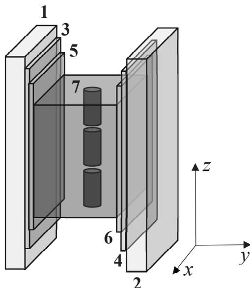
Рис. 1. Схематическое изображение слоистой структуры ЖК-ячейки. 1, 2 — стеклянные подложки; 3, 4 — слои ИТО-электродов; 5, 6 — полимерные ориентирующие слои, натертые в направлении  $z$ ; 7 — слой ЖК (E7) с красителем DCM (оси цилиндров указывают направление директора ЖК)
