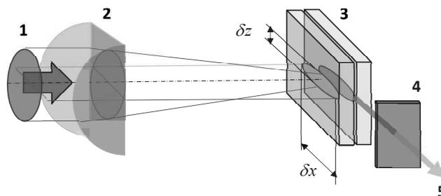
Рис. 2. Схема возбуждения люминесценции в слое ЖК, 1 — лазерный пучок ( $\lambda = 532.8$  нм,  $\tau = 10$  нс); 2 — цилиндрическая линза (фокусное расстояние 100 мм, характерные размеры области фокусировки  $\delta z = 0.1$  мм;  $\delta x = 3$  мм); 3 — жидкокристаллическая ячейка; 4 — набор оптических фильтров и поляризатор; 5 — излучение, регистрируемое оптоволоконным спектрометром
