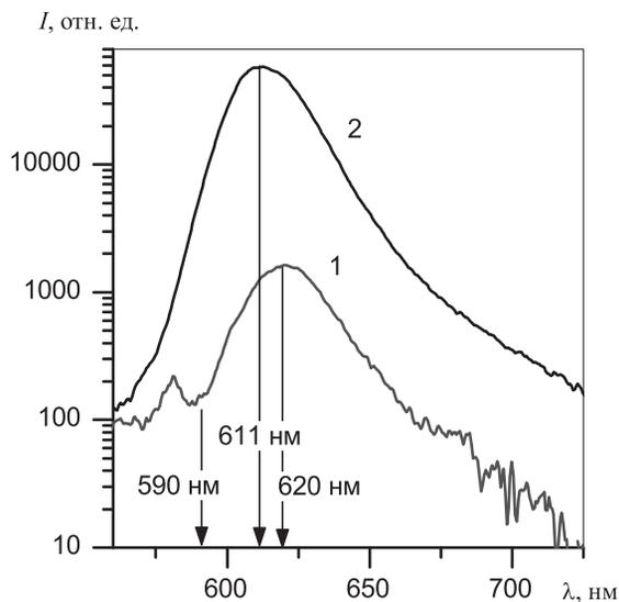
**Рис. 6.** Спектры неполяризованной люминесценции для образца № 2 (кривая 1,  $d = 6.8$  мкм) и для образца № 5 (кривая 2,  $d = 6.3$  мкм). Расстояние от центра накачки до края ЖК-ячейки  $x_0 = 1.5$  мм
