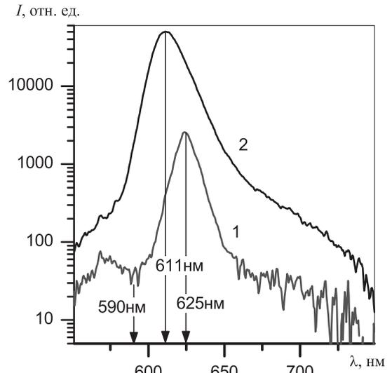
Рис. 5. Спектры неполяризованной люминесценции для образца №3 (кривая 1,  $d = 2.4$  мкм) и для образца №4 (кривая 2,  $d = 12$  мкм). Расстояние от центра накачки до края ЖК-ячейки  $x_0 = 2.5$  мм
