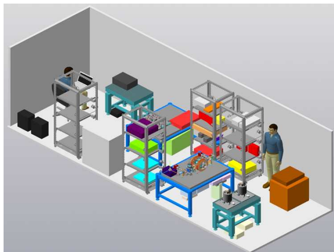
Рис. 1. Проектируемое расположение составных частей ОСЧ в фургоне. Фургон разделен на три отсека: отсек оператора, отсек физической части ОСЧ и отсек измерения частот. В отсеке оператора располагаются персональный компьютер с системой управления и источники бесперебойного питания. В отсеке с физической частью ОСЧ расположены оптический спектрометр, схема распределения излучений и вспомогательное оборудование. В последнем отсеке расположены высокостабильные лазерные системы и фемтосекундный синтезатор оптический частот
