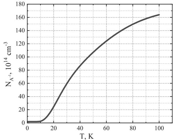
Рис. 3. Зависимость от температуры равновесной концентрации  $A_2^{-1}$ -центров вакансий ртути в слое HgCdTe с долей Cd в растворе  $x = 17.7\%$ . Концентрация компенсирующих доноров составляет  $N_D = 2 \cdot 10^{14} \text{ см}^{-3}$ , концентрация вакансий ртути  $N_A = 2.5 \cdot 10^{16} \text{ см}^{-3}$
