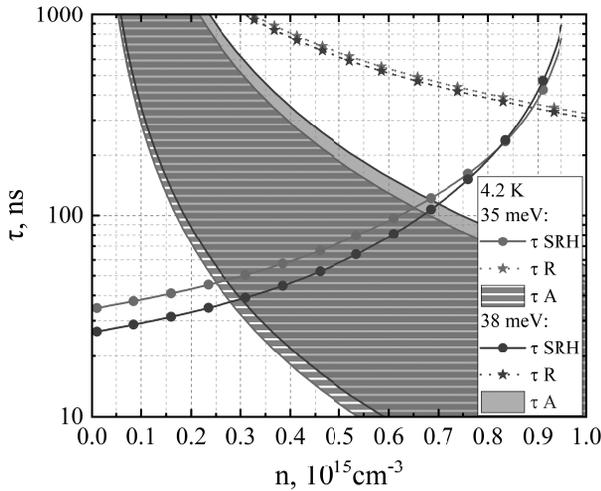
Рис. 2. Рассчитанные для  $T = 4.2$  К времена рекомбинации в HgCdTe  $p$ -типа в зависимости от концентрации свободных электронов в зоне проводимости. Концентрация компенсирующих доноров равна  $10^{15} \text{ см}^{-3}$
