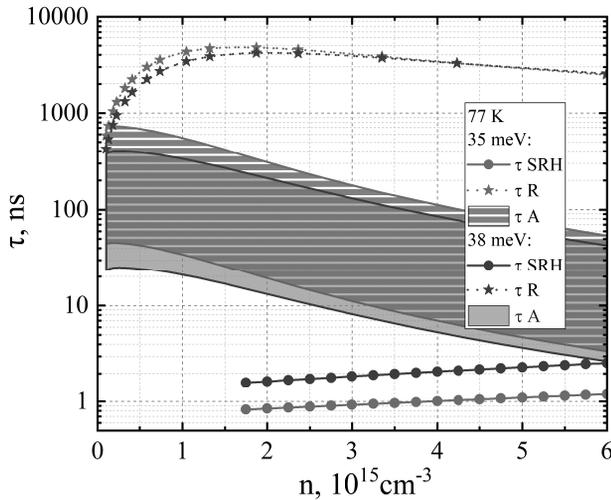
**Рис. 4.** Рассчитанные для  $T = 77$  К времена рекомбинации в HgCdTe  $p$ -типа в зависимости от концентрации свободных электронов в зоне проводимости. Концентрация компенсирующих доноров составляет  $N_D = 2 \cdot 10^{14} \text{ см}^{-3}$ , концентрация вакансий ртути  $N_A = 2.5 \cdot 10^{16} \text{ см}^{-3}$
