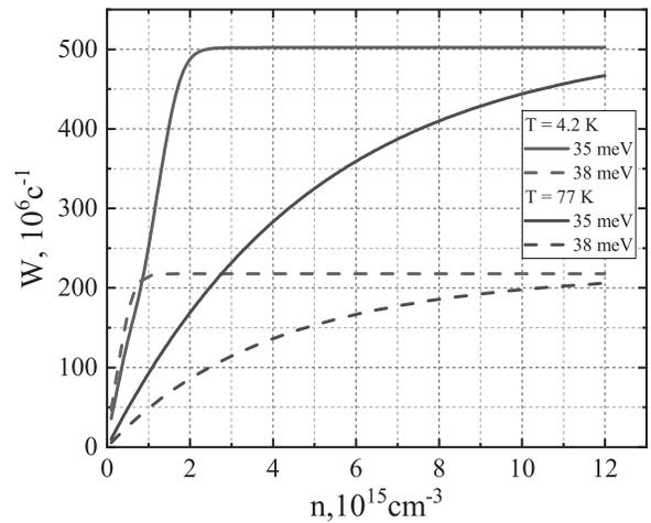
Рис. 1. Рассчитанные частоты переходов электронов из зоны проводимости на  $A_2^{-1}$ -центр в зависимости от их концентрации при различных значениях ширины запрещенной зоны HgCdTe. Расчет выполнен для диапазона концентраций от  $10^{13} \text{ см}^{-3}$  до  $1.2 \cdot 10^{16} \text{ см}^{-3}$
