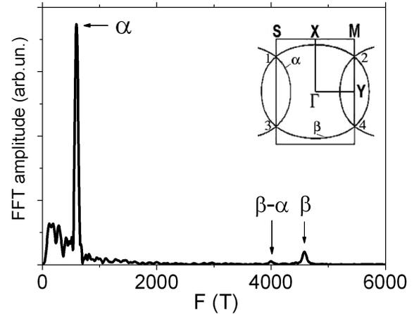
Рис. 1. Фурье-спектр осцилляций ШдГ в  $\kappa$ -(BEDT-TTF)<sub>2</sub>Hg(SCN)<sub>2</sub>Cl при  $P = 0.7$  кбар,  $T = 0.5$  К. На вставке: схематическое изображение поверхности Ферми в проводящей плоскости [9]
