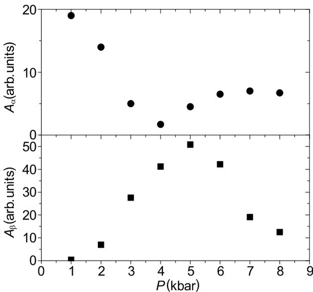
Рис. 6. Зависимость амплитуд  $\alpha$ - и  $\beta$ -осцилляций ШдГ от давления при  $T = 0.5$  К
