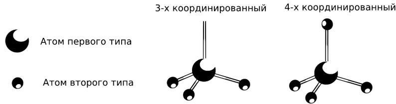
Рис. 1. Атомы Cd, окруженные атомами Se. Справа представлен полностью скоординированный атом кадмия (4с), а слева показан трехкоординированный атом Cd (3с)
